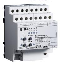
Je nach Parametrierung kann der Aktor als Schaltaktor oder als Jalousieaktor eingesetzt werden. Auch Mischformen aus Schalt- und Jalousieaktor sind möglich. Für die Funktion Jalousieaktor werden zwei benachbarte Relaisausgänge zu einem Jalousieausgang zusammengefasst.
